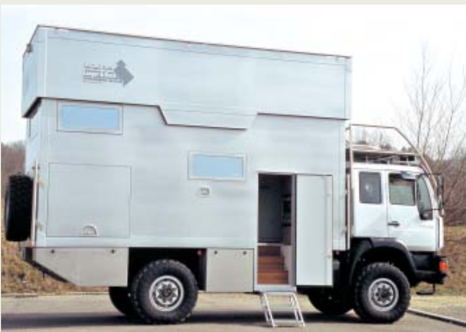
Turmhoch: Ausgefahren ist der Hubkabinen-Aufbau stolze 4,65 Meter hoch.
