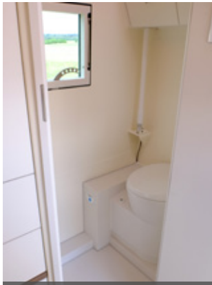
Ein-G-fügt: Die Nasszelle ist vorne links in die Kabine implantiert.
